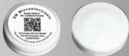
O BEACON é um dispositivo do tipo BLE 4.1 e faz parte da família de BEACONS compactos, dotados de bateria do tipo moeda.
