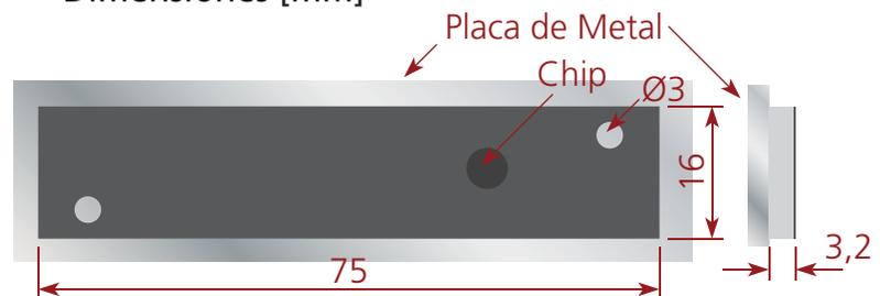
Obs.: Instalar el Tag o Chip vuelto para el lado opuesto del metal.
